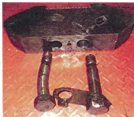
Damaged balance weight bolts and balance weight (損傷したバランスとバランスウエイトボルト)
